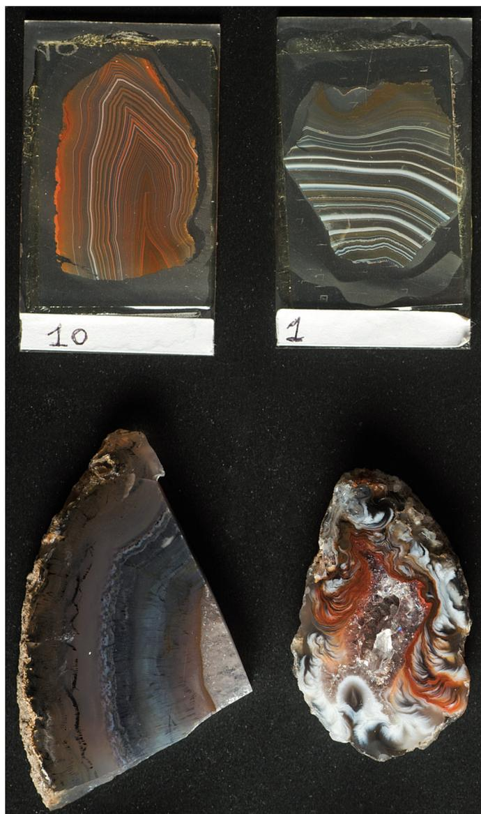
Fig. 1 – Due sezioni sottili (in alto) e due piccole lastre di agata (in basso) da cui si possono ricavare sezioni sottili. Le dimensioni di una sezione sottile sono 27x47 mm. Lo spessore del vetrino è di 1 mm e lo spessore della fetta di roccia sulla sezione sottile è di 30  $\mu\text{m}$  (foto S. Castelli).
