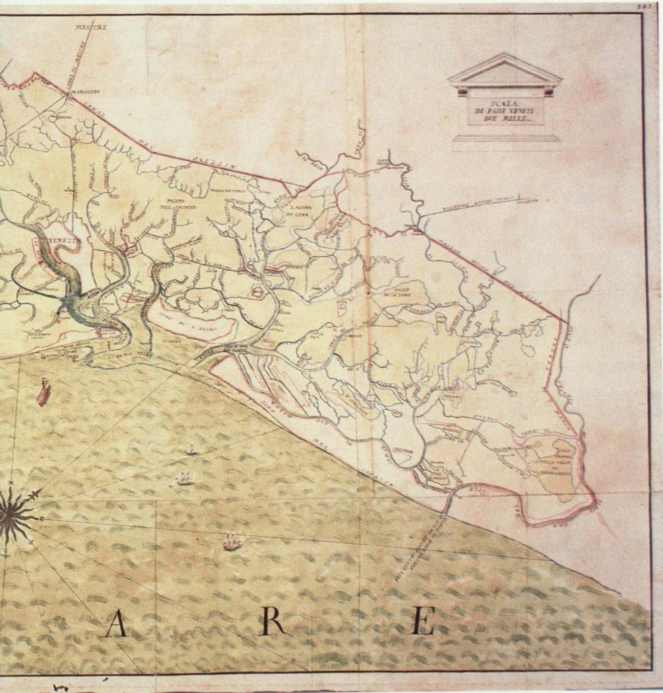
FIG. 5 - XVIII secolo (seconda metà). Disegno della laguna di Venezia con indicato in rosso il tracciato della linea di conterminazione. Archivio proprio Poleni, reg. 3.
