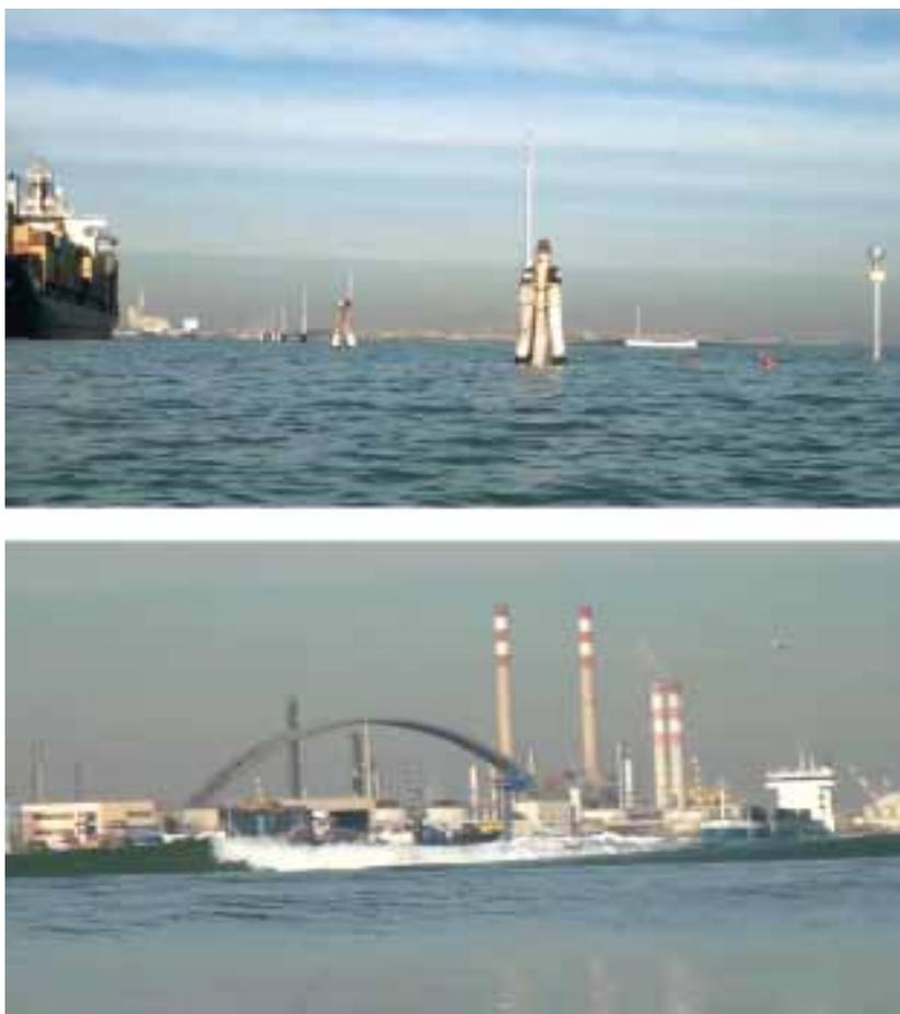
Fig. 9 - Onde frangenti generate dal passaggio di una nave lungo la via navigabile Malamocco-Marghera che si propagano sui bassifondi adiacenti al canale. In alto una vista generale della nave e dell'onda che frange sui bassioni; in basso un particolare dell'onda frangente. Sono tali onde ad alimentare i processi erosivi che si osservano in vicinanza del canale e che hanno causato in circa 40 anni incrementi delle profondità che in alcune zone superano i 2 m (vd. Figg. 3 e 4).
