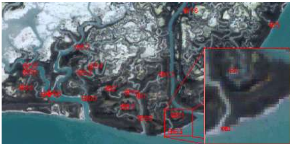
Fig.3.3 - Posizionamento dei GCP acquisiti presso S.Felice sull'immagine multispettrale a colori reali.
