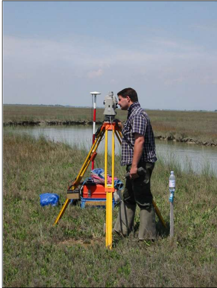
Fig.5.1 - Teodolite laser per la misurazione della quota.
