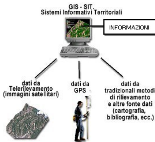
Figura 2: Schema strutturale di un sistema SIT/GIS. tratto da: http://www.proeco.it/gis/gis_cosa_dwn.htm
