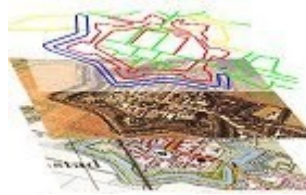
Figura 3: Esempio di struttura a stati separati (livelli) in un sistema CAD-GIS tratto da: http://www.proeco.it/gis/gis_cosa_dwn.htm
