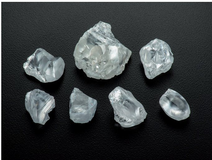
Figura 4 - Tipici diamanti super profondi con morfologie irregolari [foto: Robert Weldon/GIA; Gem Diamonds Ltd.].
